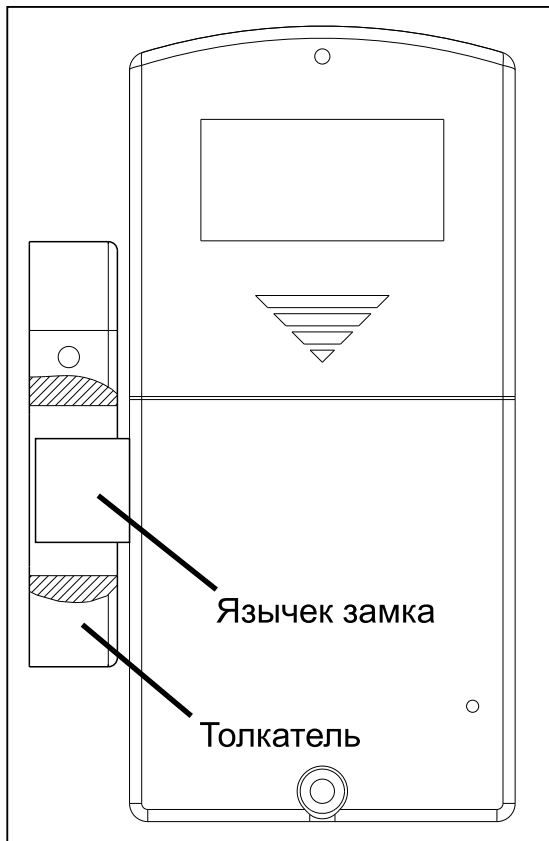
Рис. 7 Правильная установка. Вид с внутренней стороны двери
